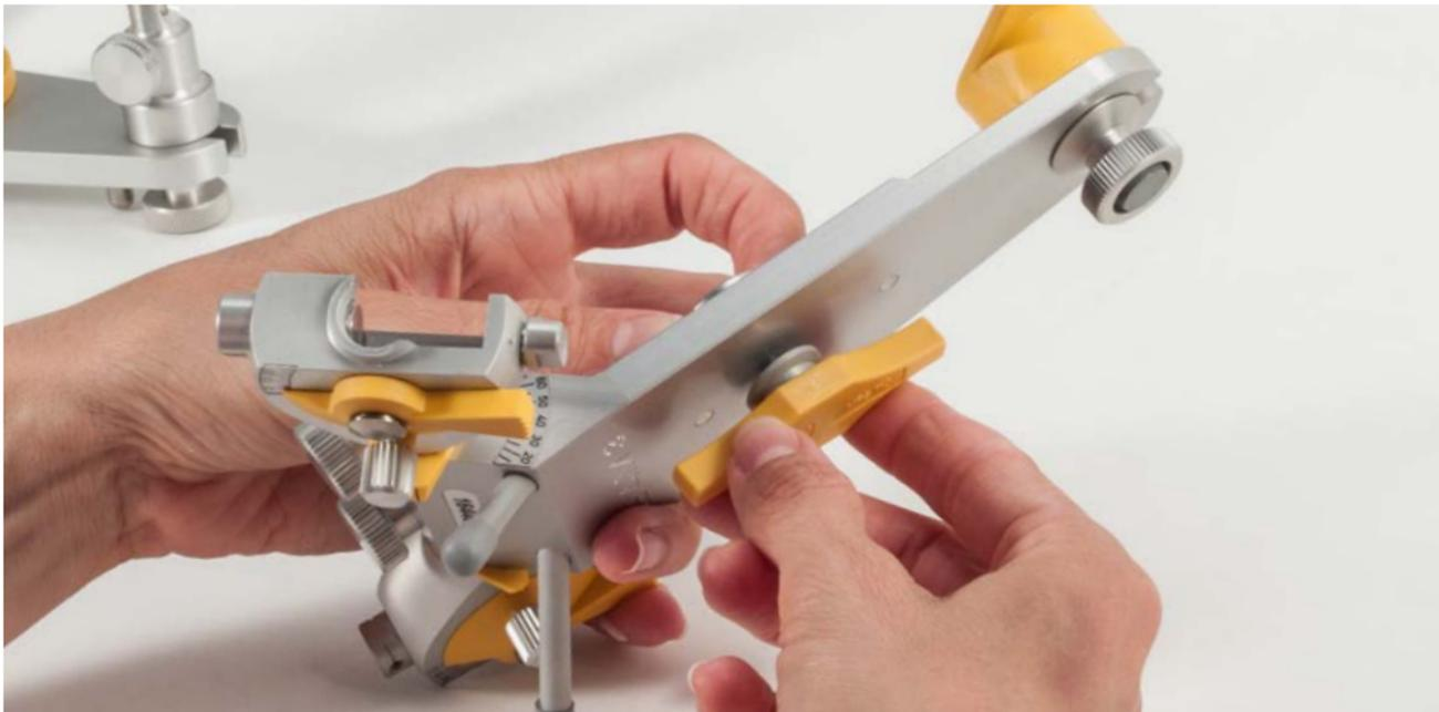
Lösen Sie die Hutmutter mit dem Kunststoffschlüssel (MPS 110) komplett, während Sie mit der anderen Hand den Magnettopf festhalten.
