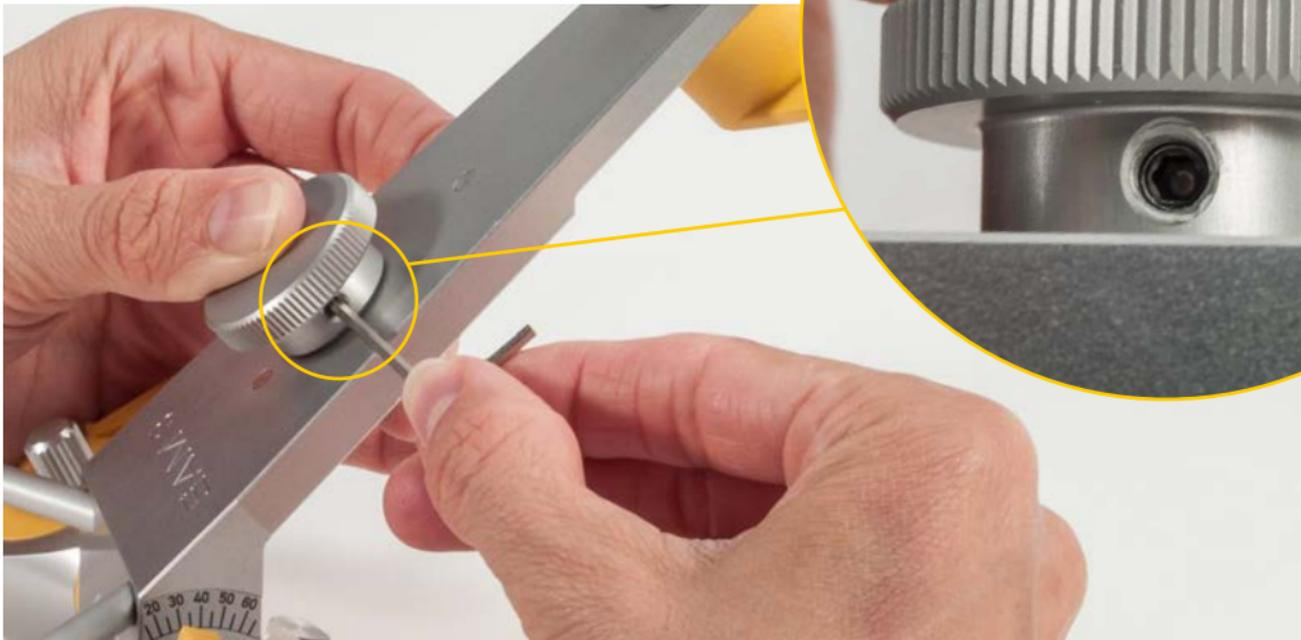
Ziehen Sie die Madenschraube mit einem 2 mm Sechskant-Schraubendreher (Inbus) fest. Die Madenschraube verbindet die Rändelbuchse fest mit dem Bolzen.
