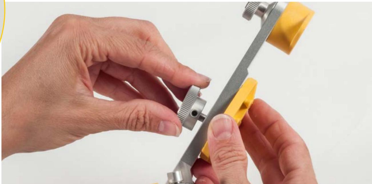
Rändelbuchse und Bolzen sind nun so gesichert, dass sie sich nicht voneinander lösen können. Jetzt kann entweder eine SAM® Schraubmontageplatte oder das SAM® AXIOSPLIT®-System jeweils innen im Artikulator eingeschraubt werden.
