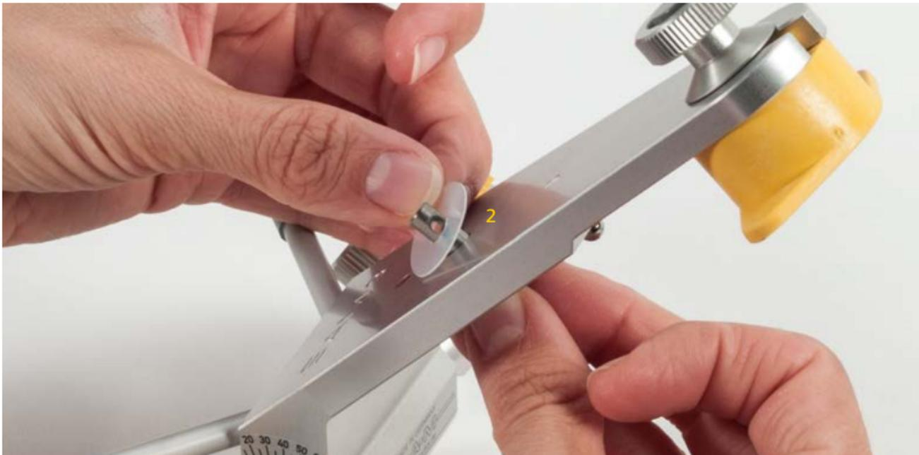
Stülpen Sie auf der Artikulatoroberseite die Polyamidscheibe (2) über den Bolzen. Diese schützt später den Artikulator vor Kratzern.
