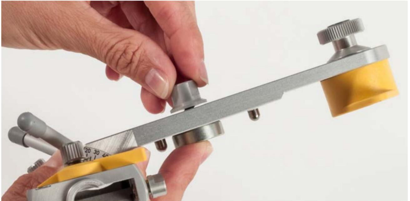
Drehen Sie die Hutmutter (MPS 186) nur locker auf das Gewinde des Magnettopf (MPS 190).
