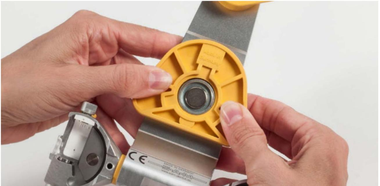
Drücken Sie die MPS-Montageplatte vollständig auf die Stifte und den Magnettopf des Artikulators.
