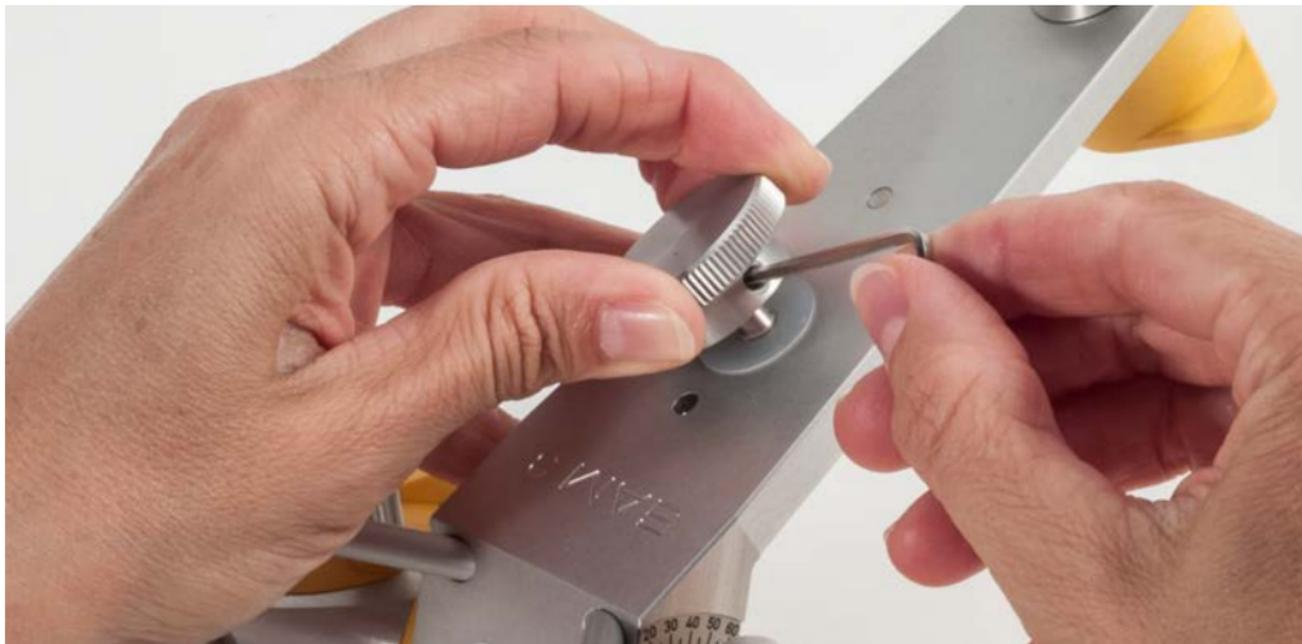
Schrauben Sie die Madenschraube mit einem 2mm Sechskant-Schraubendreher (Inbus) komplett aus der Rändelbuchse.
