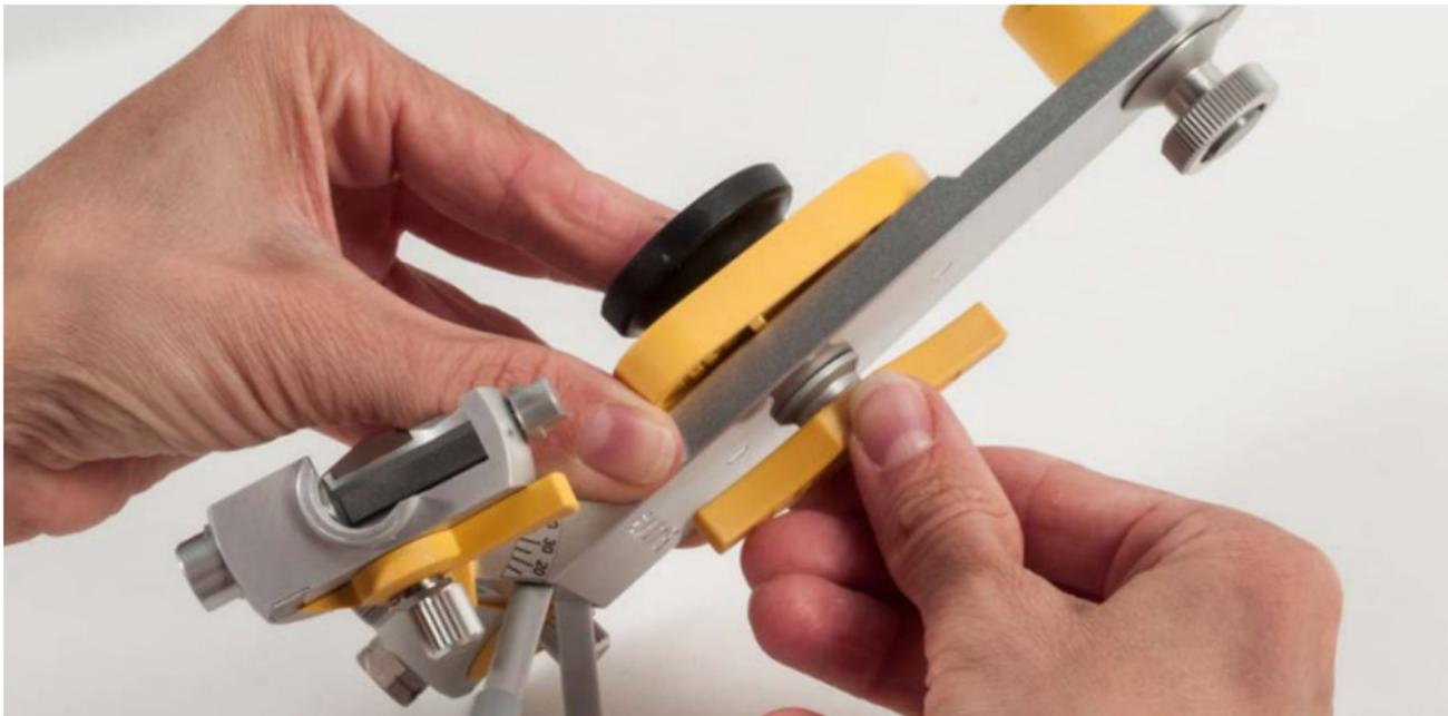
Ziehen Sie die Hutmutter mit dem Kunststoffschlüssel (MPS 110) fest. **Achtung:** Metallische Werkzeuge können die Hutmutter beschädigen. Verwenden Sie stattdessen die SAM®-Schlüssel.
